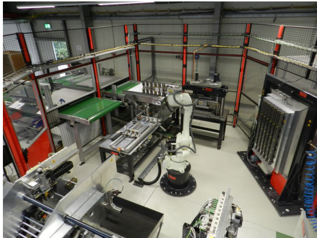
Der Kawasaki Roboter RS020N verbindet sämtliche Prozessschritte der Rohrverarbeitung innerhalb der Zelle
