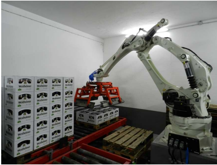
Der Kawasaki Roboter CP500L palettiert befüllte Kisten in der Brauerei
