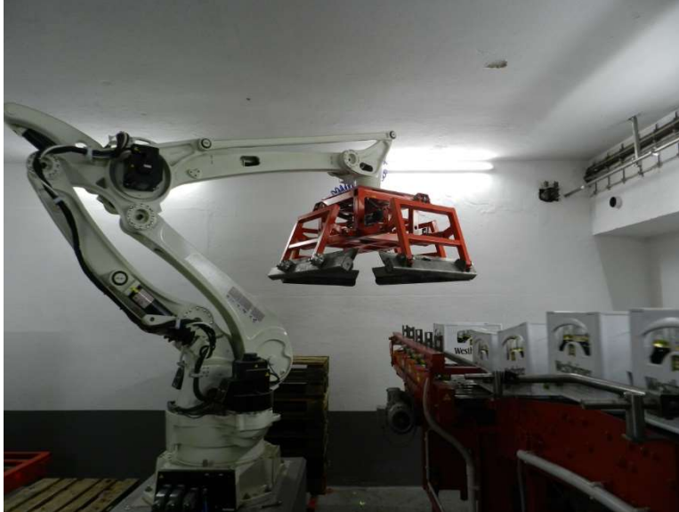
Der Kawasaki Roboter CP700L fertigt mehr als 1.200 Kästen pro Stunde ab.
