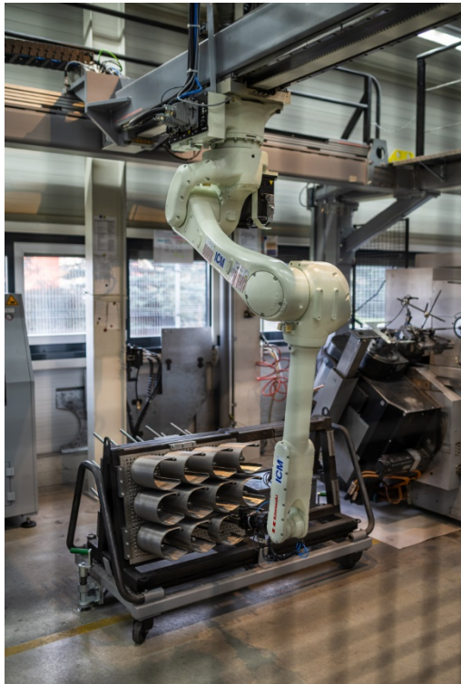
Der Kawasaki RS010L führt die fertigen Bieeteile präzise einem Register zu.
